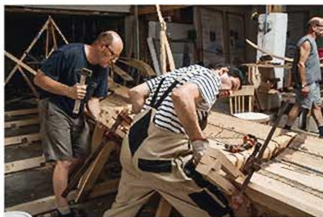
Reprise du montage des quatrième et cinquième virures du bordé.
